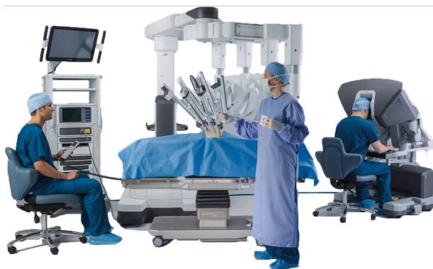
図 3：Da Vinci サージカルシステムはペイシェントカート、ビジョンカート、サージョンコンソールの構成よりなる。術者は患者と離れて手術操作を行う。
